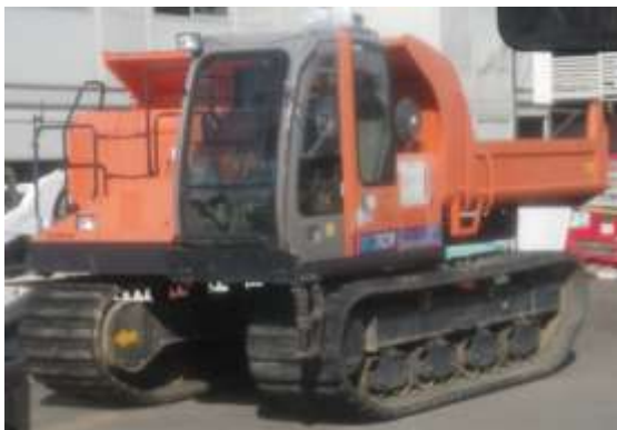
クローラードンプ（可搬式消防ポンプや仮設ヘッダーを運搬する車両）
