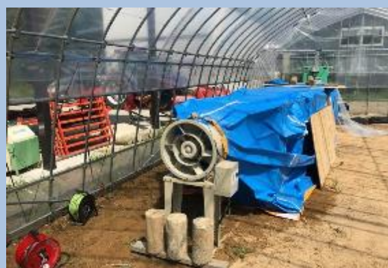
たまねぎ温風乾燥機導入により腐敗が少なくなり単収が向上
