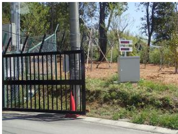
処分場入口のモニタリングポスト表示盤
