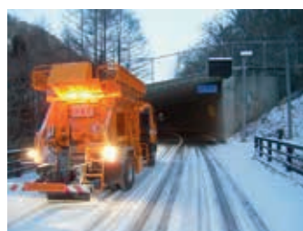
凍結抑制剤散布車の散布状況
