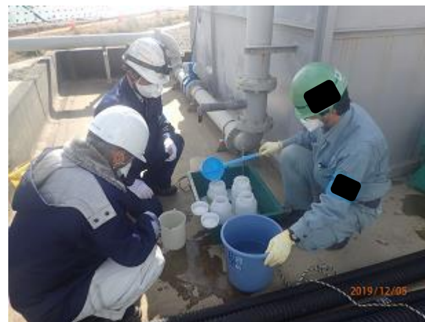
土壌貯蔵施設放流水の測定
