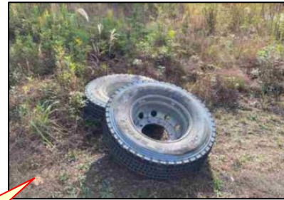
【脱落したタイヤ】
