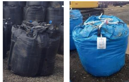
図1 保管容器（左：大型土のう、右：フレキシブルコンテナバッグ）
