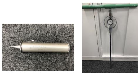
図2 測定機器（左：山中式土壤硬度計、右：コーンペネトロメータ）
