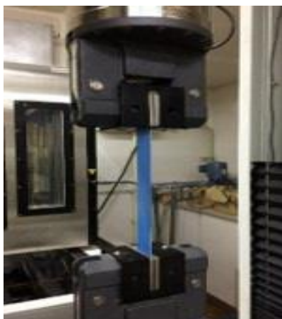
図3 容器生地の引張試験の様子
