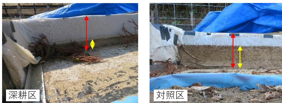
図8 土壌侵食マスの状況 (2021年2月15日の豪雨後)
