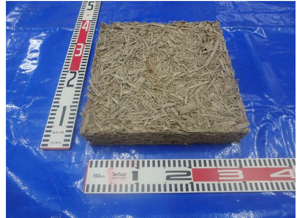
図-2 バーク板(縦横 30cm×厚 6cm、重量 2.7kg)
