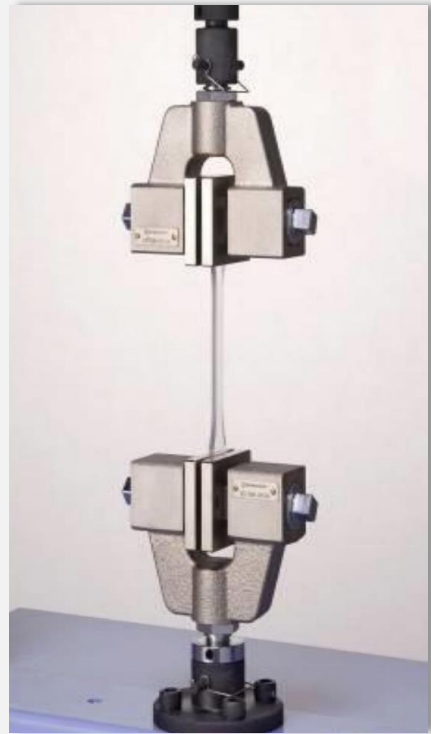
図1 JIS L 1096滑脱抵抗力を参考 B法糸引抜き法を応用した試験片作製条件
