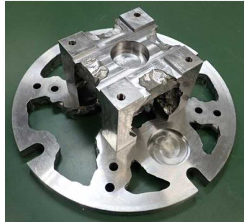
製作した最適化治具 (13.28kg)
