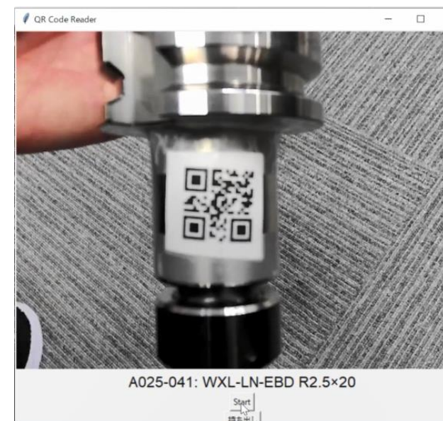
図2 QRコードによる工具の持ち出し処理
