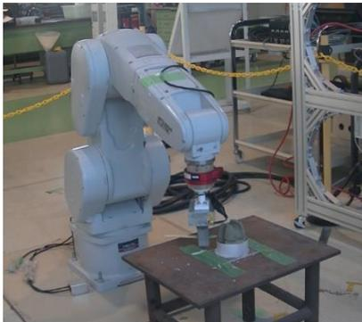
図8 ロボットのバリ取り状況
