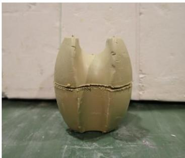
図9 ロボットによるバリ取り後の玉碓子
