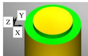
図3 C軸回転のみの加工形状
