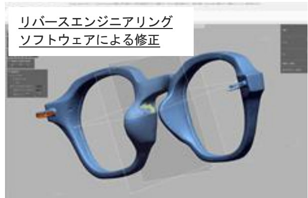
図7 3D サーフェイスモデルの作成
