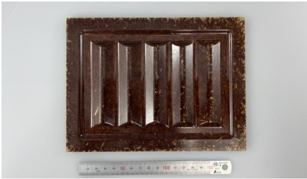
図8 波形部材（フェノール樹脂含浸）
