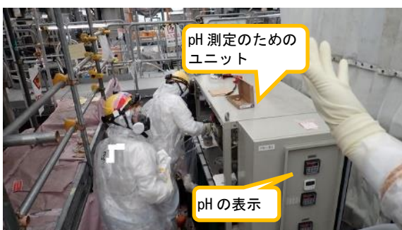
(写真2) pH計の校正作業の状況
