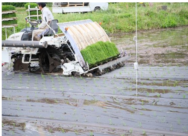
紙マルチ田植え機による移植作業（5月20日）
