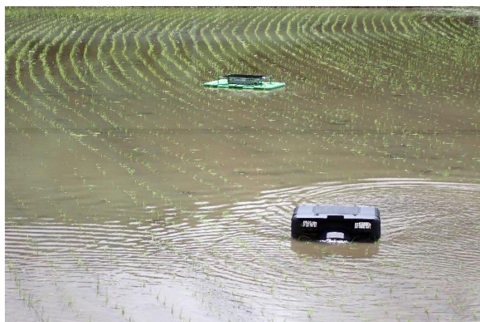
自動航行するアイガモロボ（奥：従来機、手前：新型機）
