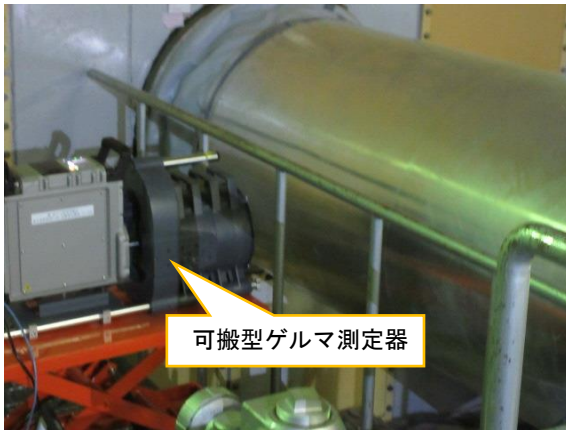
(写真 1 - 2) 配管付着放射能測定の様況②
