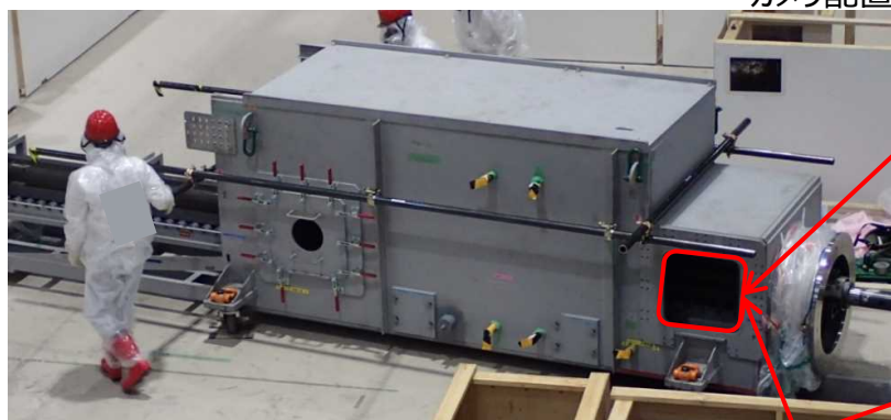
エンクロージャ模擬体 (神戸工場)
