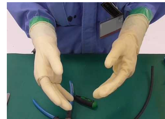
手元装備 (綿手袋+ゴム手袋3重) ※ケーブル接続作業時は革手袋を追加
