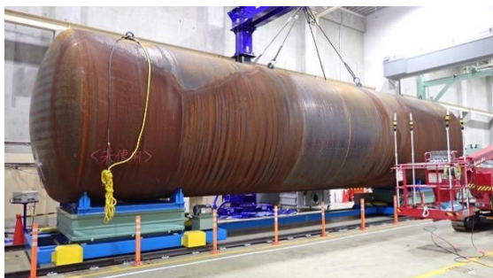
(写真2-1) 搬入ブースにおけるブルータンクの状況① ※茶色く見えるのはブルータンクの鋼材。青い塗装は剥ががしている。
