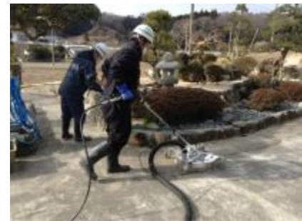
吸引型高压洗浄機車載機器
