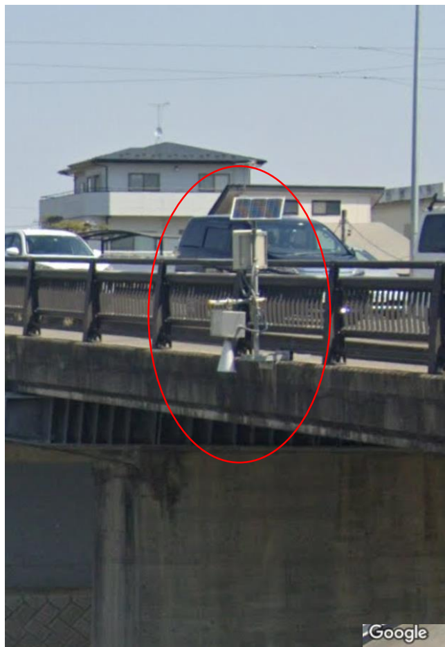
水位計の設置状況 ＜逢瀬川（逢瀬橋）・郡山市＞
