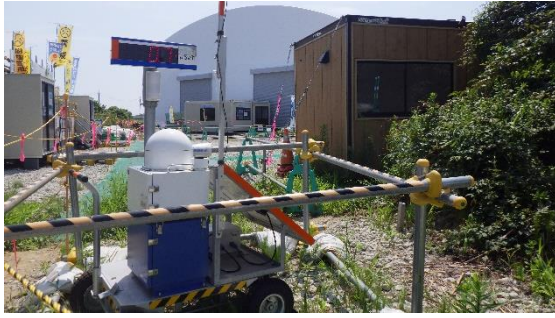
(写真3) 線量表示器の設置状況 (確認時の指示値 : 0.7 \mu Sv/h)
