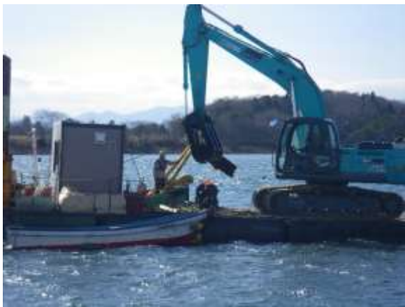
起重機船による漁場内に残存したがれき等の除去作業
