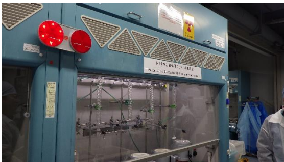
(写真2-1) エリア区分けの例（トリチウム前処理エリア（極低濃度）） 写真左上の赤いランプは火気使用の標示（確認時はヒーターを使用）
