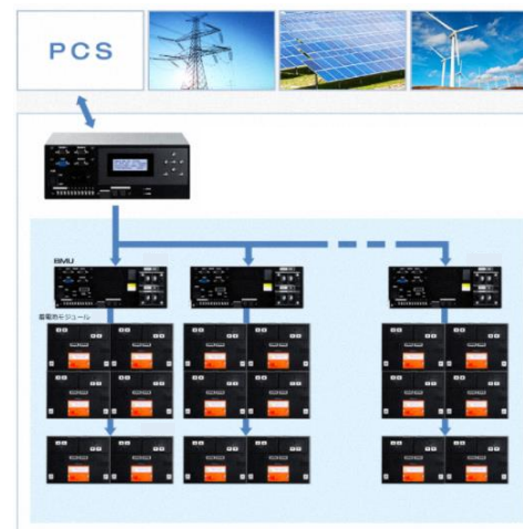
メガワット級蓄電池システム例
