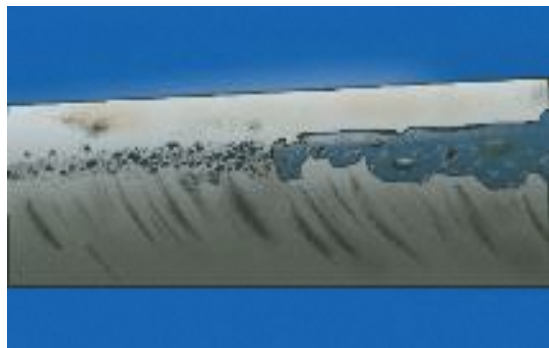
エロージョンによるブレード表面劣化
