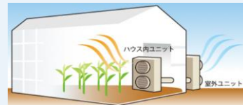
【地中熱ヒートポンプ設備イメージ】
