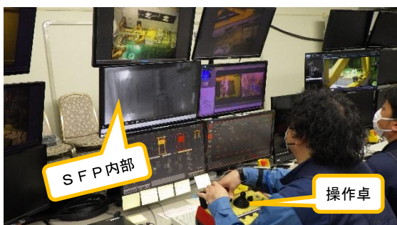
(写真1) 遠隔操作室でクレーンに取付けられた吊具のリモート操作を行う作業員 (3号機オペフロでの現場作業を実施している作業員と連携して操作)
