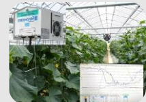
園芸施設の環境測定装置
