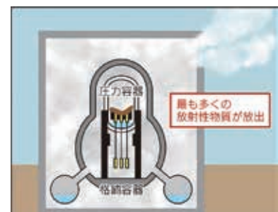
2号機の原子炉格納容器が破損し、放射性物質が放出
