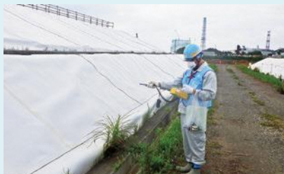
ガレキ類一時保管施設の放射線量を確認の様子
