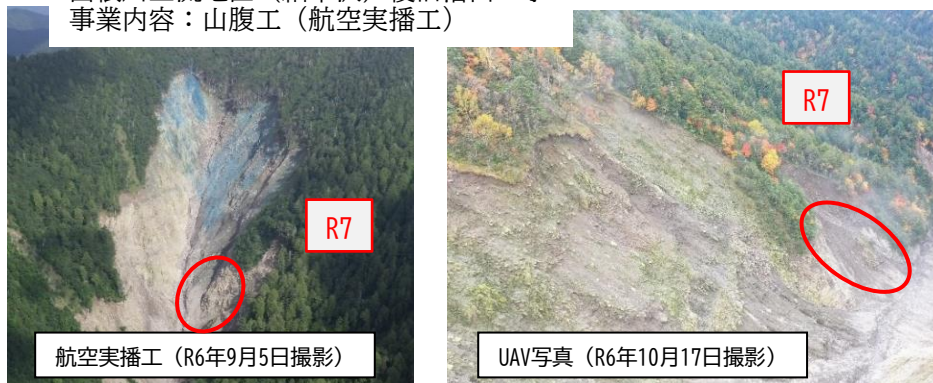
西根川上流地区（細木沢）復旧治山工事 事業内容：山腹工（航空実播工）
